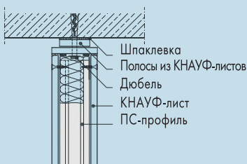
Вариант примыкания перегородки к перекрытию с теньвым швом
